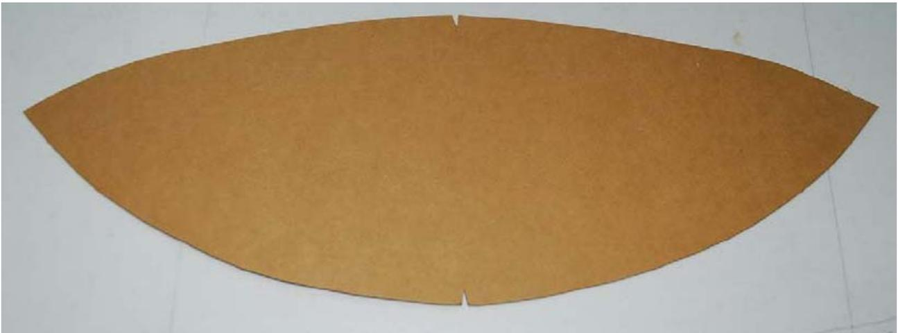
I costruttori debbono considerare che il taglio della parte superiore del pezzo di materiale conduttore sia fatto secondo un profilo curvo. Poiché una volta, applicato alla bavetta della maschera, la parte superiore curva diventi una linea orizzontale.
